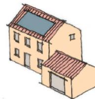
Les toitures 4 pentes, en plus du fait qu'elles ne correspondent que très peu aux registres des toitures locales et rendent difficiles les extensions, sont particulièrement inadaptées à l'installation de panneaux.
